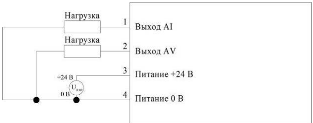
Рисунок 4.17.2 – Схема подключения СР6741
