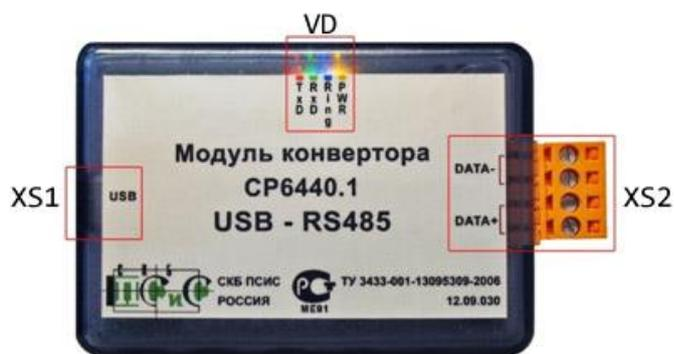
Рисунок 1. Внешний вид модуля.
